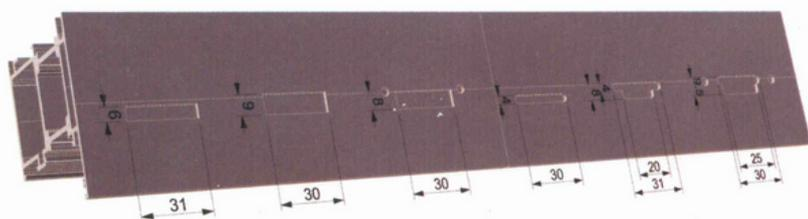
Queste sono alcune lavorazioni (esempi di tranciatura) nel profilo in cui va inserita la cappetta di drenaggio FIBI.
